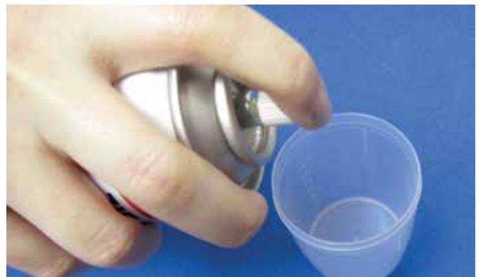
**FIGURA 3:** O acelerador de cianoacrilato é colocado em recipiente plástico
