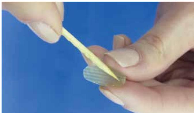
**FIGURA 1:** Aplicação de fina camada de cola de cianoacrilato sobre a lâmina plástica com auxílio de palito de madeira
