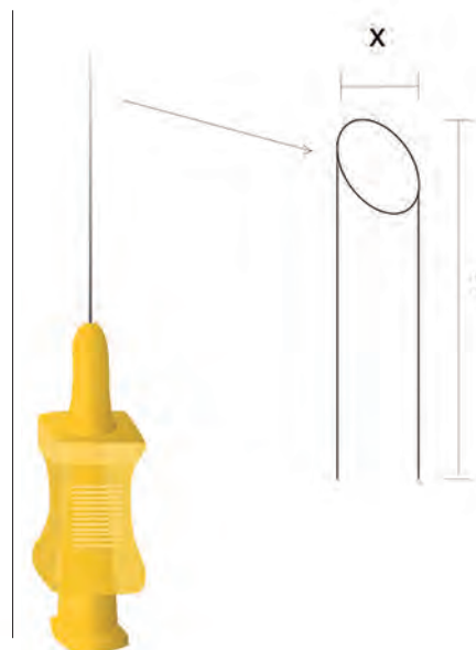
FIGURA 2: Relação entre calibre (X) e comprimento (Y) da cânula
