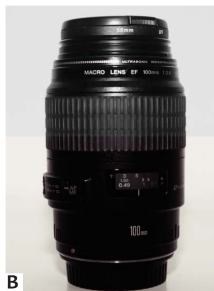
FIGURA 13 – A) Câmera DSLR – 14,5 X 6,5 (no grip) X 8,5 cm; B) Lente Macro verdadeira DF 100m, abertura fixa em 2,8. Flash externo acoplado à câmera, é vendido separadamente. Propriedade da autora.
