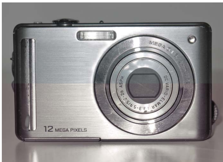
Figura 12: Câmera compacta – dimensões: (comprimento X profundidade X altura): 9 X 2 X 5,5 cm. Propriedade da autora.
