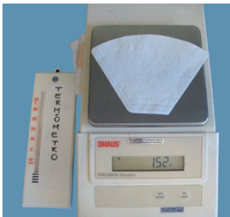
FIGURA 2: Termômetro e balança de precisão utilizados na gravimetria
