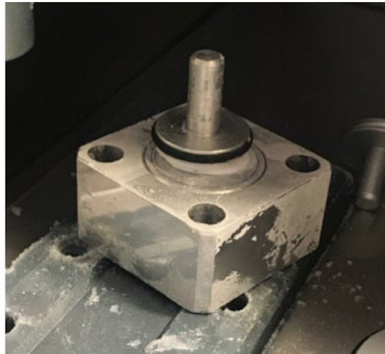
FIGURA 4: A - Modo de funcionamento com achatamento direto da amostra na superfície metálica; B - O bloco pronto para ser desprendido e ir para a microtomia.
