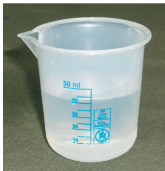
Figura 1 – Becker autoclavável de 50 ml e com escala milimetrada. Notar nível da solução de 40 ml.
